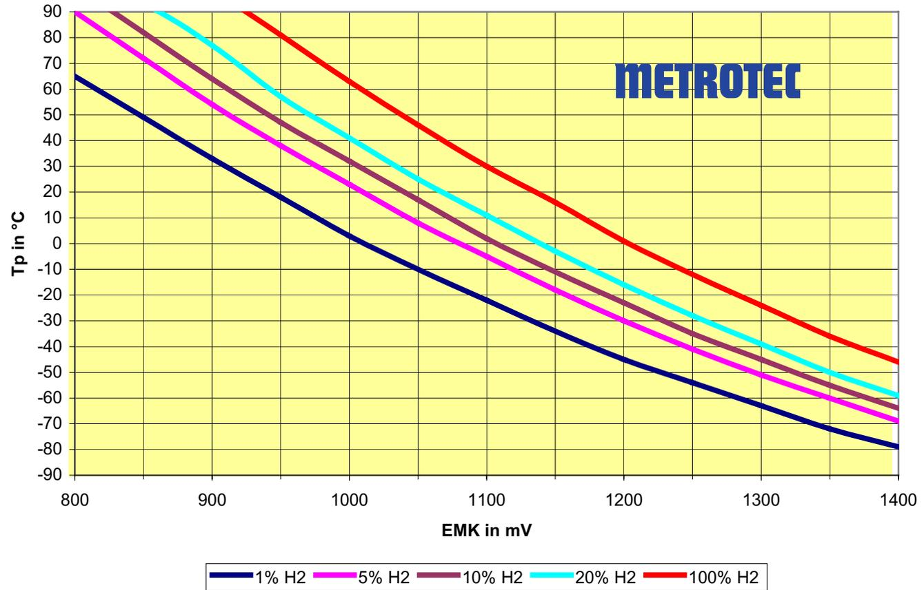
Gasgemisch aus Stickstoff/Wasserstoff bei einer Sensortemperatur von 700°C
